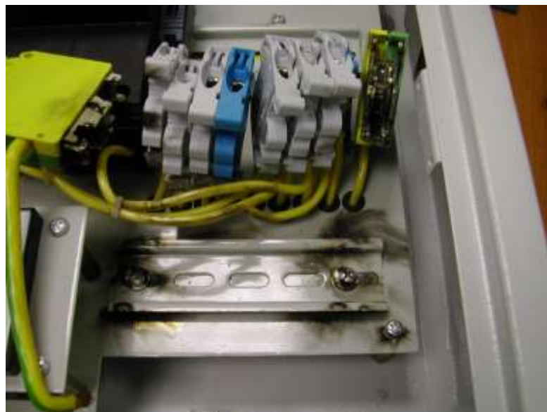
Рис. 10 Состояние ножевых контактов после импульсного воздействия.
