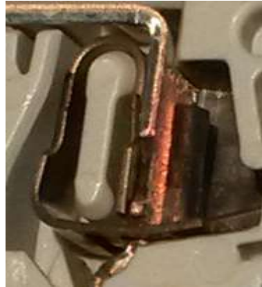
Рис. 9 Состояние плоско-пружинного зажима после испытаний.
