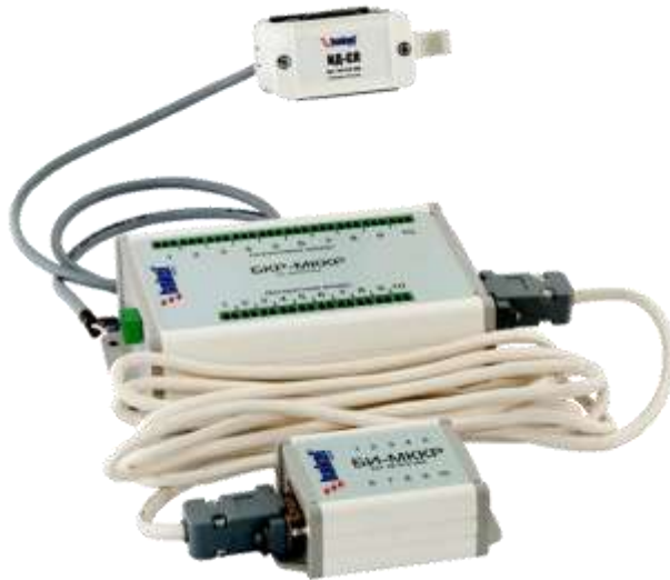
Рис.11 Внешний вид и конструктивное исполнение МККР на 10 измерительных каналов.
