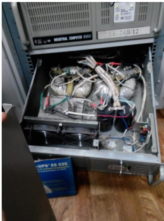
Рис.2 Блок питания со снятой крышкой
