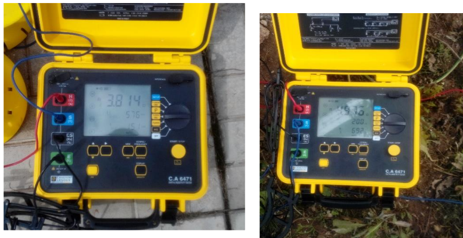
Рис.8 Измерения сопротивлений растеканию ЗУ
