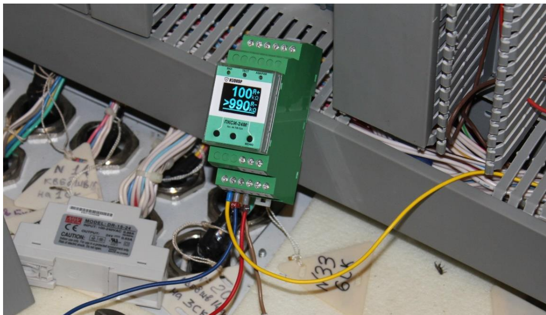
Рисунок 7 – Изменение показаний ПКСИ-24М при имитации утечки изоляции на первом проводе
