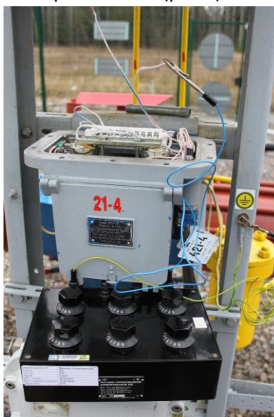
Рисунок 3 – Подключение магазина сопротивлений к кабелю КИП узла управления ЭПУУ-5
