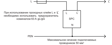
Схема подключения устройств серии SPC на примере SPC 1.1 («V» соединение)
