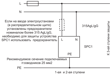
Схема подключения устройств SPC1 и SPC1.0 для системы TN-S
